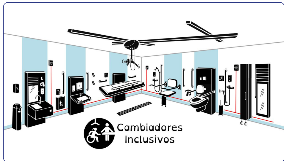
Imagen 1: Elementos que componen un Cambiador Inclusivo. Imagen cedida por cambiadoresinclusivos.org
